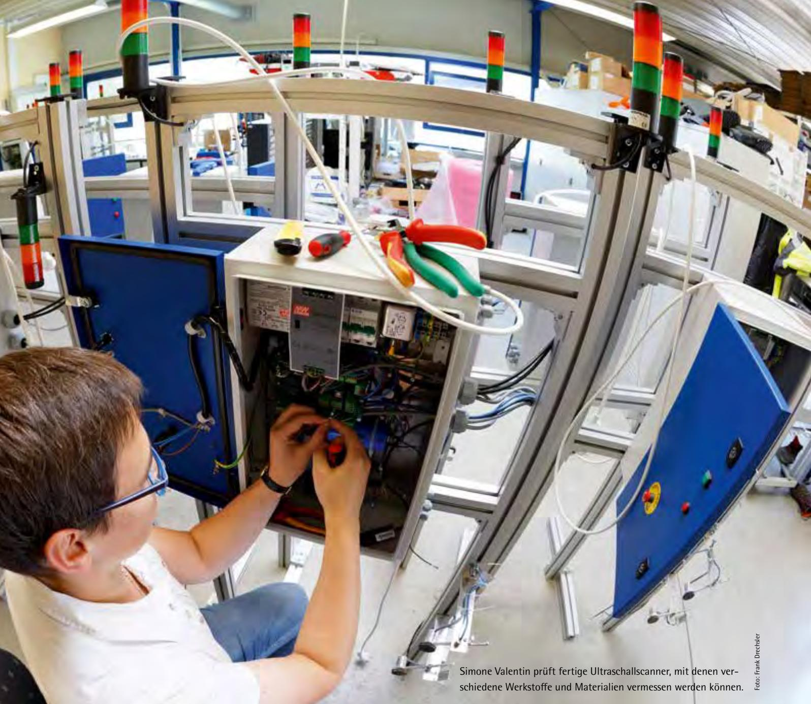
Simone Valentin prüft fertige Ultraschallscanner, mit denen verschiedene Werkstoffe und Materialien vermessen werden können.
