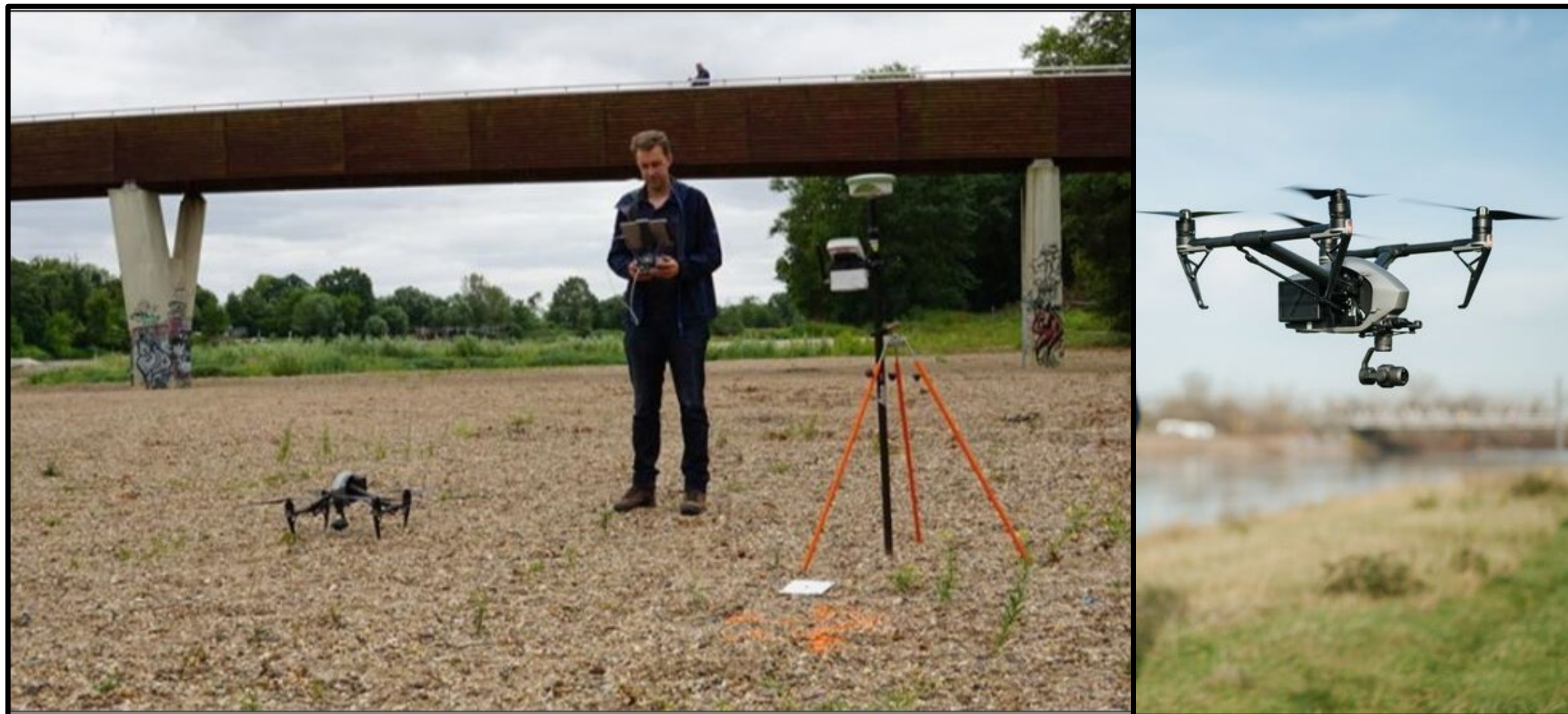
Abb.2: Einsatz der Drohne im Gelände mit beispielhaftem Kontrollpunkt (weiße Plakette) und Prüfpunkt (orange Markierung) [links, Foto: B. Ettmer] und Drohne im Flug [rechts, Foto: D. Hesse]
